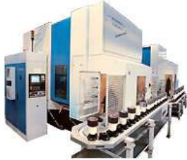
Richardon R300 CNC (Vollautomat mit Entgrateinheit für Komplettfertigung)
