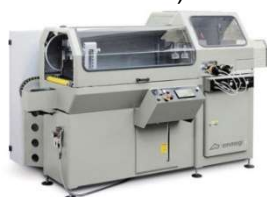
Automatica E VA-650 Inkoma (Kreissägevollautomat für Buntmetalle)
